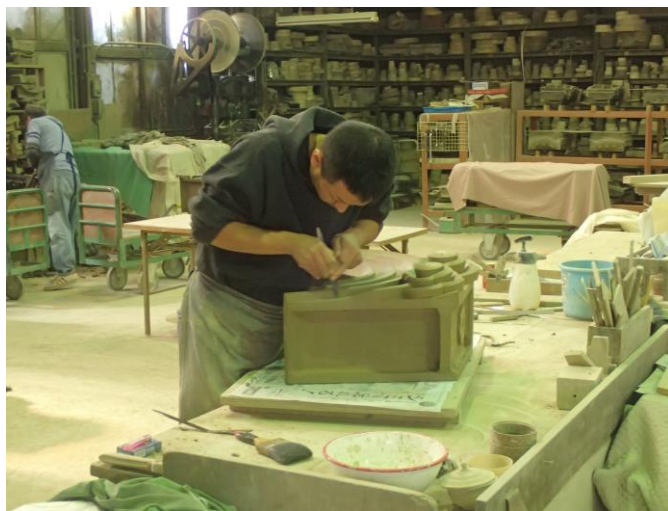
鬼瓦の削り出し工程(写真撮影は、すべて浅井さん)
